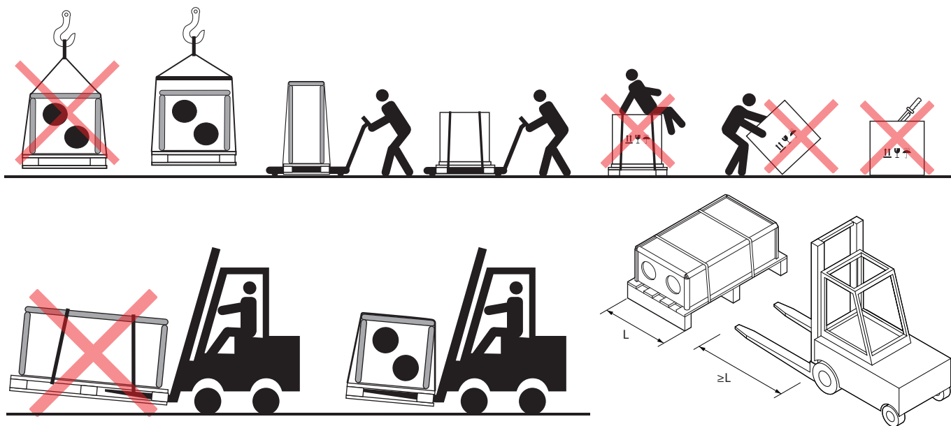
Obr. 4. Příklady přepravy pomocí jeřábu, vysokozdvizného vozíku a nízkého vozíku
